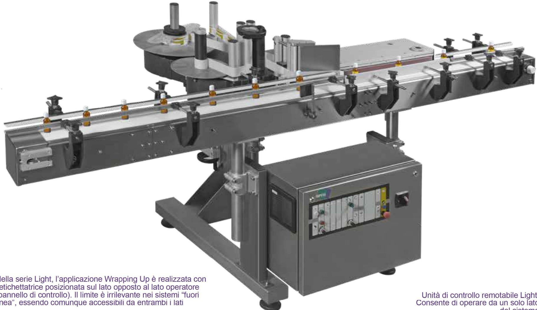
Nella serie Light, l'applicazione Wrapping Up è realizzata con l'etichettatrice posizionata sul lato opposto al lato operatore (pannello di controllo). Il limite è irrilevante nei sistemi "fuori linea", essendo comunque accessibili da entrambi i lati
